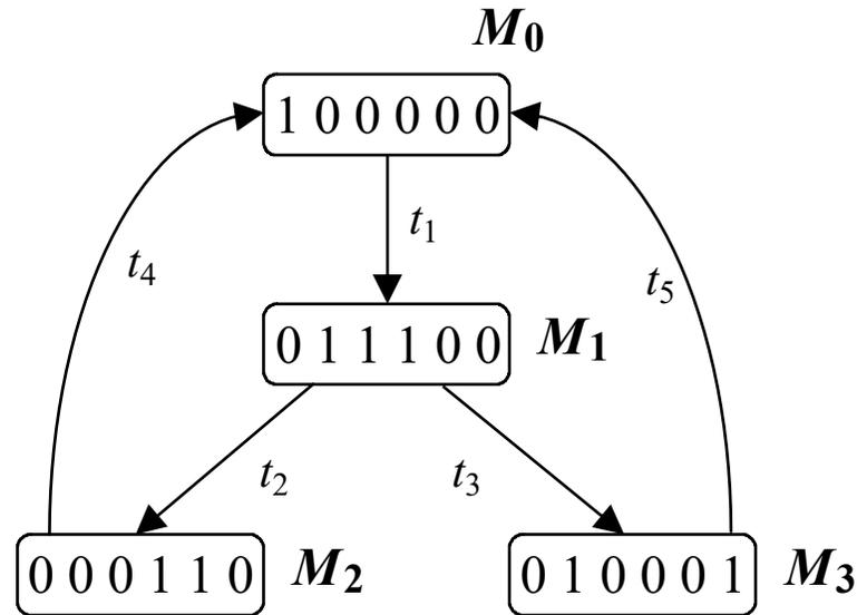
Pour ce RdP avec  $M_0 = (1, 0, 0, 0, 0, 0)$ , le modèle est borné à 1, i.e., le RdP  $\langle N1, M_0 \rangle$  est sauf.
